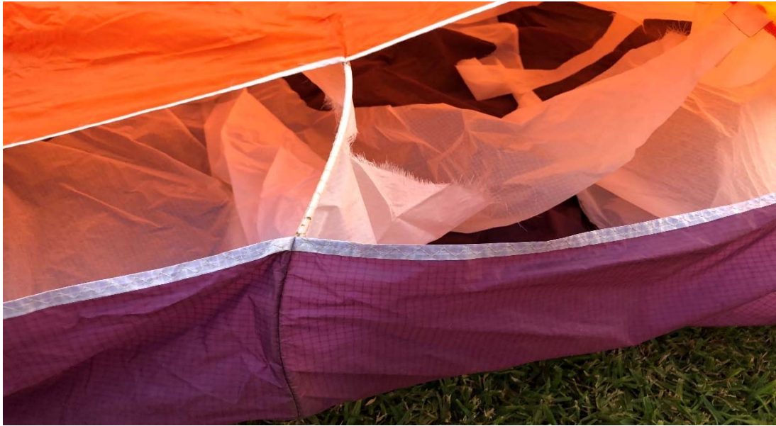
Φωτ. 1: Διαρρηγμένα ribs στο εσωτερικό της πτέρυγας.
