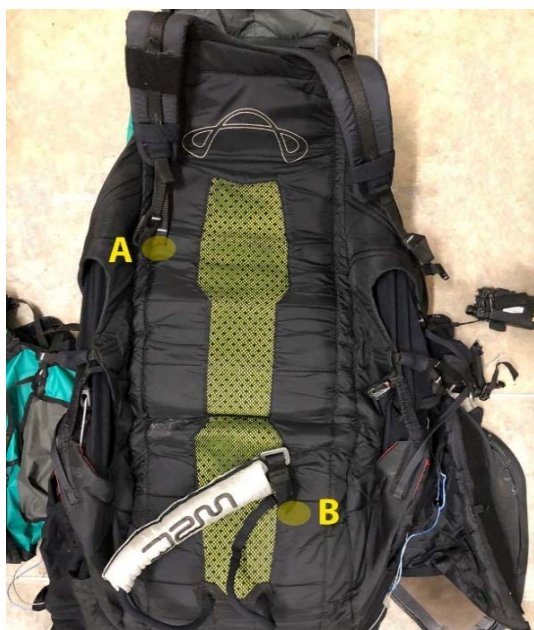
Φωτ. 4: Το κάθισμα με κομμένους μάντες στα σημεία A και B.
