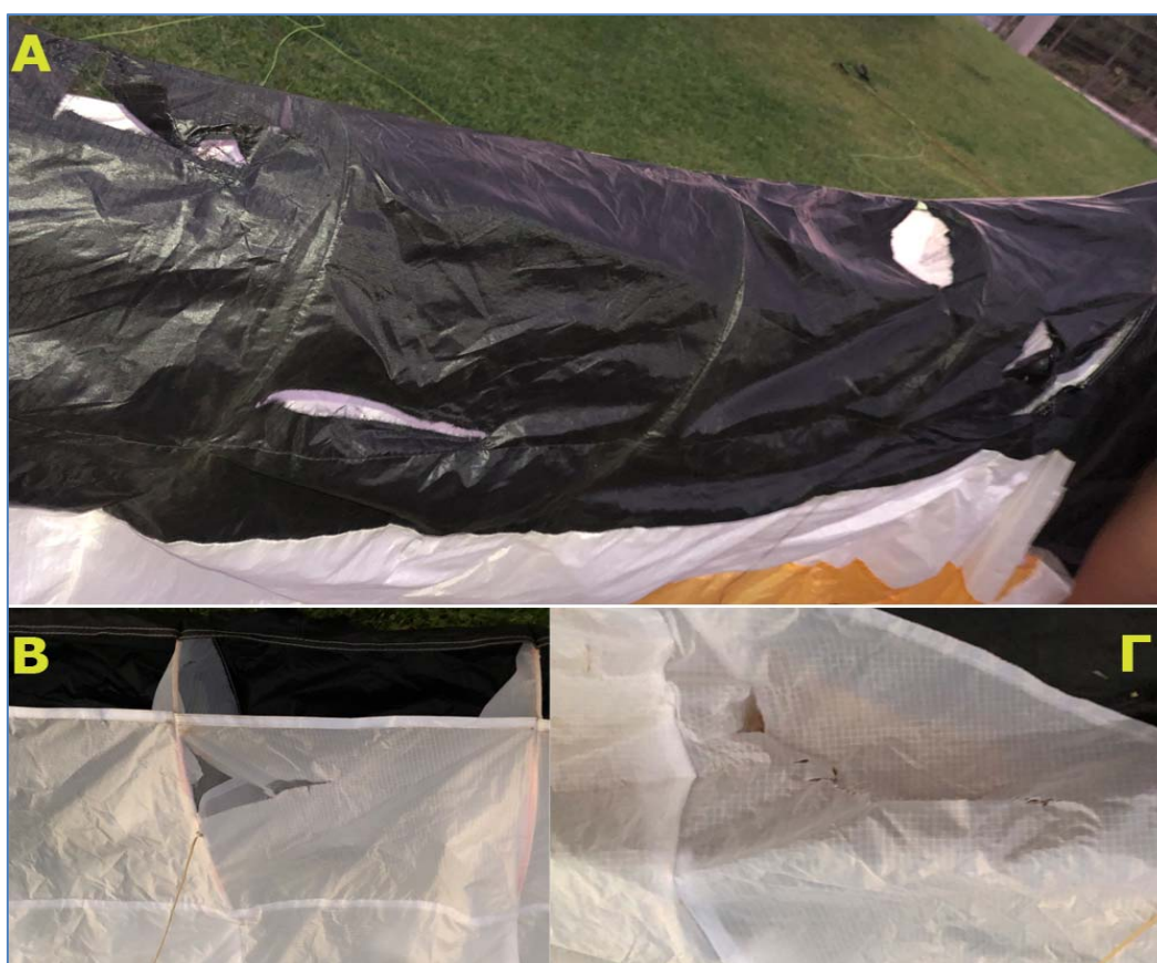
Φωτ. 1: Σχισμές στην πτέρυγα του αλεξιπτώτου.
